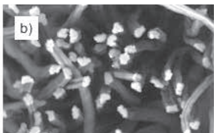
شکل ۱- عکس‌های SEM از نخ ۱۰۰٪ ویسکوز -a نمای طولی نخ -b سطح مقطع نخ
