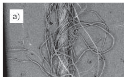
شکل ۱- عکس‌های SEM از نخ ۱۰۰٪ ویسکوز -a نمای طولی نخ -b سطح مقطع نخ
